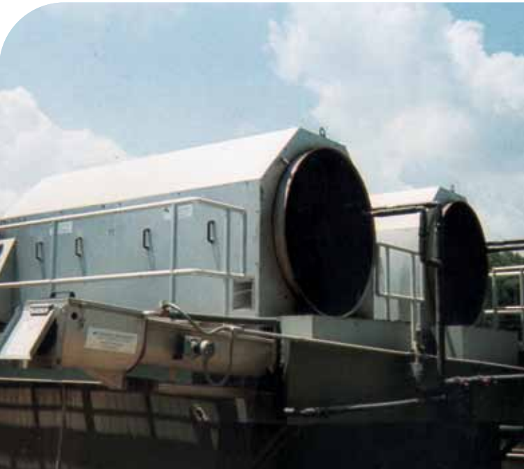
La construcción con alambre tipo cuña maximiza la captura de sólidos
